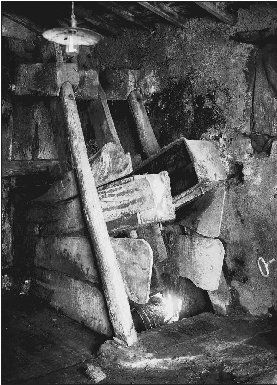
022 - Nella fotografia LAP dei primi anni del '900 l'esterno del meccanismo dei folloni a martello
